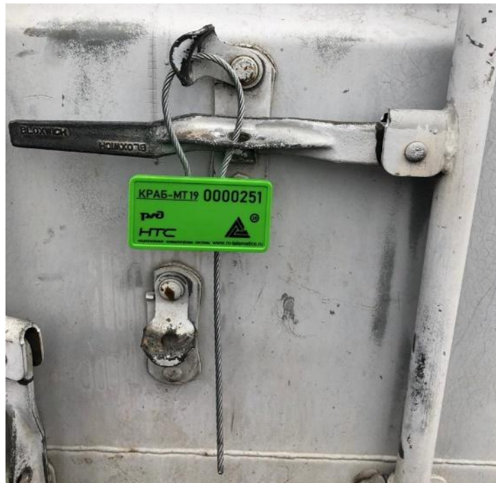
Рис. 2 – пример установки КРАБ–МТ19 на вагон
